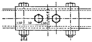
Ø = I4mm (tube≥40mm<50mm diam. ext.) l6mm (tube≥50mm diam. ext.)
